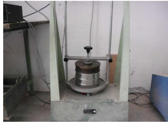
Vagli setacciatori su vibrovagli per separare particelle di differenti dimensioni
