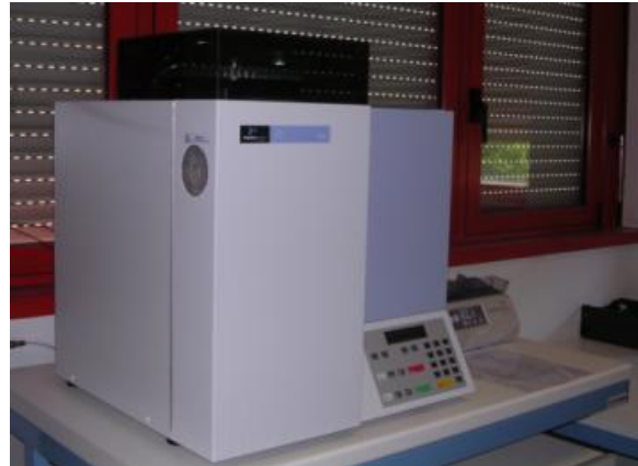
Analizzatore elementare in dotazione al Laboratorio Biomasse
